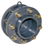
U-PVC Flanş Bağlantılı Çalparalı Çekvalf (Takım - 316 Paslanmaz Civata - Somun - Pul)
